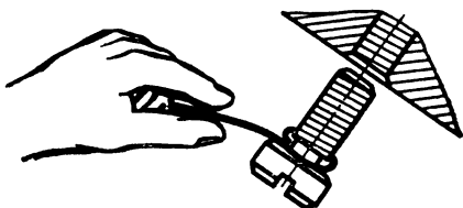
Рис. 17. Поддержка винта посредством проволочной петли
